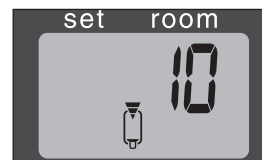
K: Après que l'indication FUEL est apparue, l'écran affichera les minutes qui vous restent avant que le réservoir soit vide.
