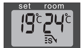
J: När SAVE-lampan tänds stängs värmaren av eller slås på automatiskt för att hålla sig inom ett specificerat temperaturintervall.
