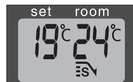
J: Wenn die Kontroll-Lampe SAVE aufleuchtet, schaltet sich der Heizofen automatisch an und aus, um innerhalb eines bestimmten Temperaturbereiches zu bleiben.
